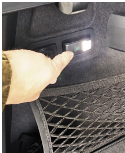
Nützliches Detail – die Kofferraumbeleuchtung (l.) lässt sich als Taschenlampe (r.) nutzen.
